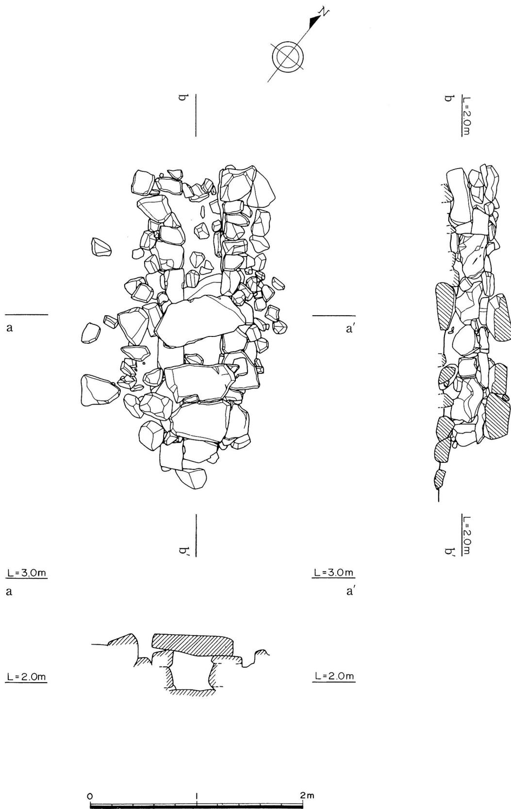
第8図 暗渠（蓋石撤去前）平面（上左）・断面図（上右・下）（S=1:40）
