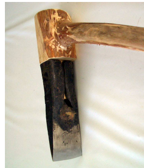
ソケットのように柄の部分を差し込みます。
