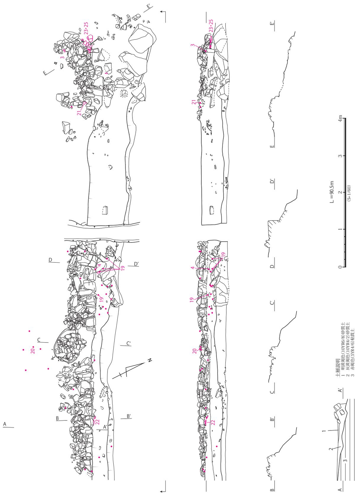
第 18 图 石垣实测图 (S=1/60)
